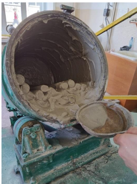
Рис. 1. Отбор пробы закладочной смеси из стержневой мельницы
