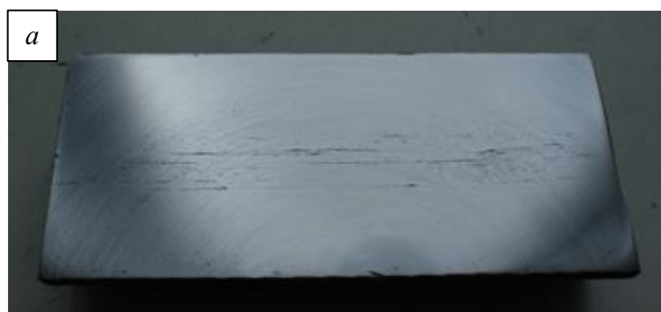
Рис. 3. Флокены в продольных образцах заготовок: а – шлифованные образцы; б – образцы после травления Fig. 3. Floccules in longitudinal samples of workpieces: а – ground samples; б – samples after etching
