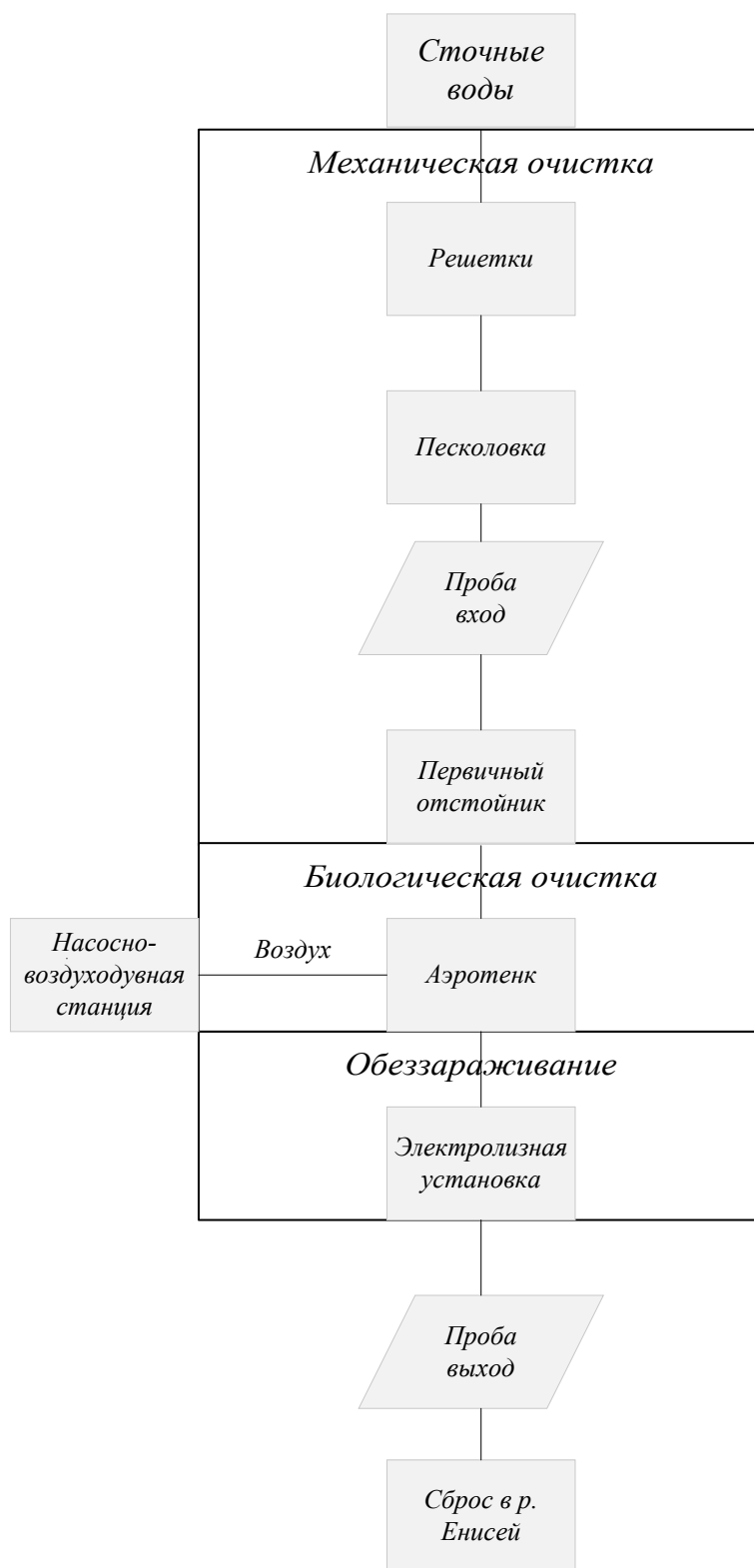
Рис. 1. Принципиальная схема очистных сооружений г. Кызыл Fig. 1. Schematic diagram of the Kyzyl wastewater treatment plant
