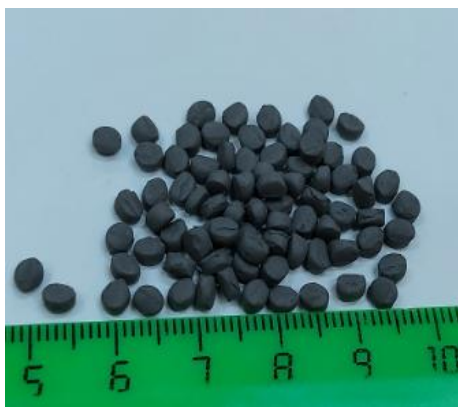
Рис. 3. Внешний вид гранулята стали марки 12X18H10T Fig. 3. Appearance of 12Cr18Ni10Ti granulate
