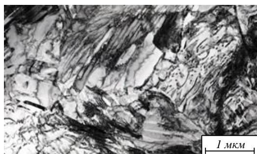
Рис. 5. Микроструктура пробы 2 рельса категории ДТ350 из стали марки Э76ХФ
