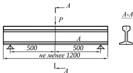
Рис. 2. Схема испытания на статический поперечный изгиб
