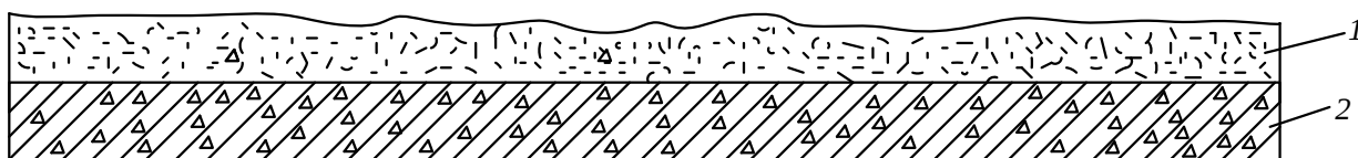
Рис. 2. Сцепление декоративного (1) и рабочего (2) слоев бетона
