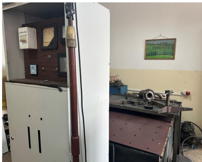
Рис. 1. Лабораторная электровзрывная установка ЭВУ 60/10 Fig. 1. Laboratory electroexplosive spray coating plant EVU 60/10
