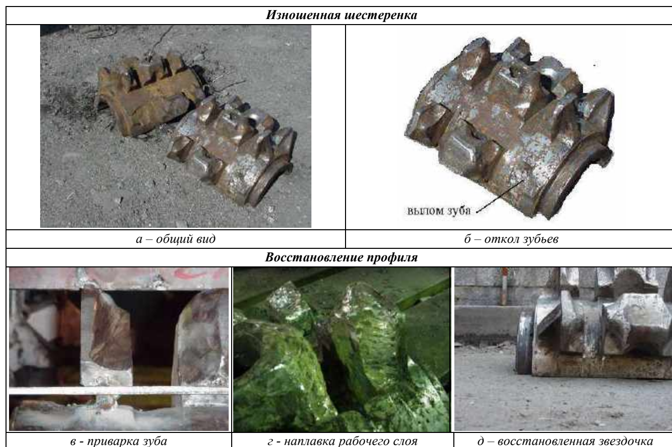
Рис. 2. Общий вид (а), откол зубьев (б) изношенной шестеренки и восстановление профиля (приварка зуба (в), наплавка рабочего слоя (г), восстановленная звездочка (д)) Fig. 2. General view (a), tooth breakage (б) of a worn gear and restoration of the profile (welding of the tooth (в), surfacing of the working layer (г), restored sprocket (д))
