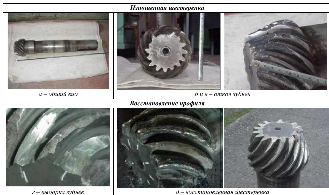
Рис. 1. Общий вид (а) и откол зубьев (б, в) изношенной шестеренки, выборка зубьев (г), восстановленная шестеренка (д, е) Fig. 1. General view (a) and tooth breakage (б, в) of a worn gear, tooth sampling (г), restored gear (д, е)
