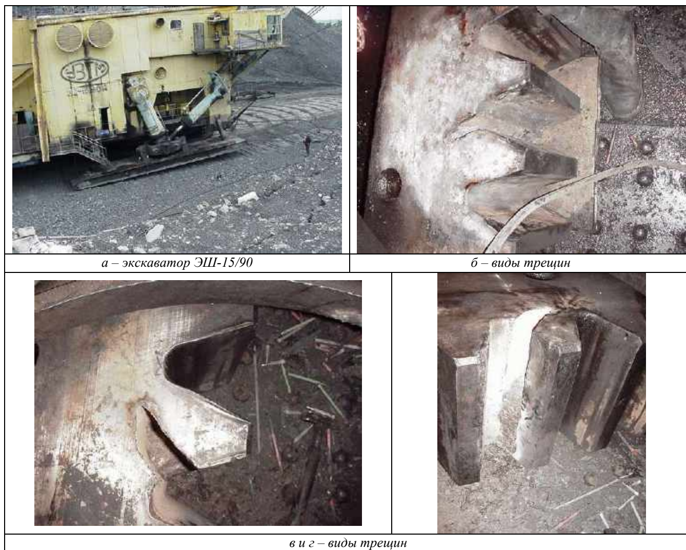
Рис. 3. Общий вид экскаватора ЭШ-15/90 (а) и виды трещин (б – з) Fig. 3. General view of the excavator ESH-15/90 (a) and types of cracks (б – з)
