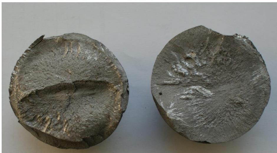
Рис. 2. Излом усталостного характера в шарах, не выдержавших испытания на ударную стойкость
