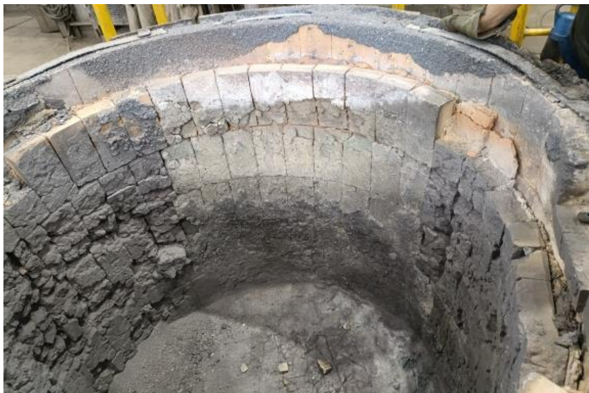
Рис. 2. Экспериментальный разливочный ковш после 23 наливов Fig. 2. Experimental filling ladle after 23 refills
