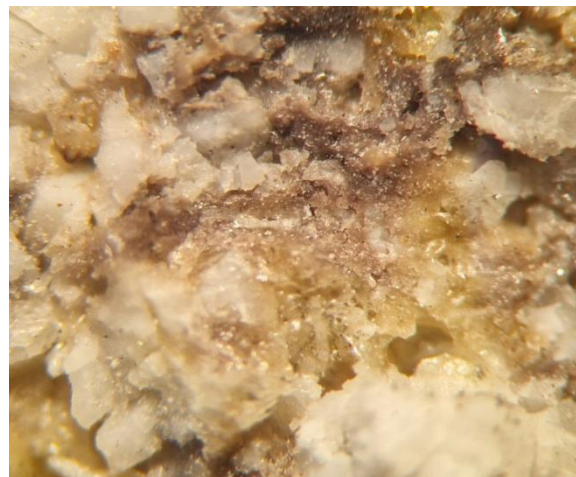
Рис. 5. Тридимитовая зона огнеупора Fig. 5. Tridymite zone of refractory
