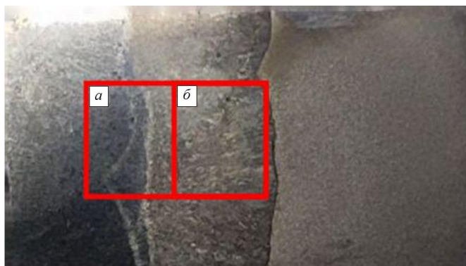
Рис. 5. Области измерения нанотвердости наплавки (а) и переходного слоя (б) Fig. 5. Areas of measurement of nanohardness of surfacing (a) and transition layer (b)
