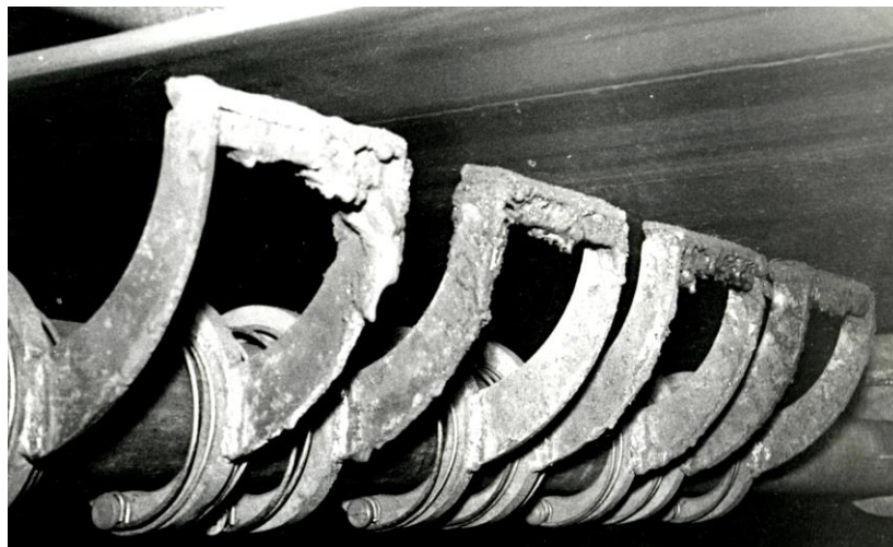
Рис. 7. Второй ряд очистных элементов устройства «Промтранс» в производственных испытаниях
