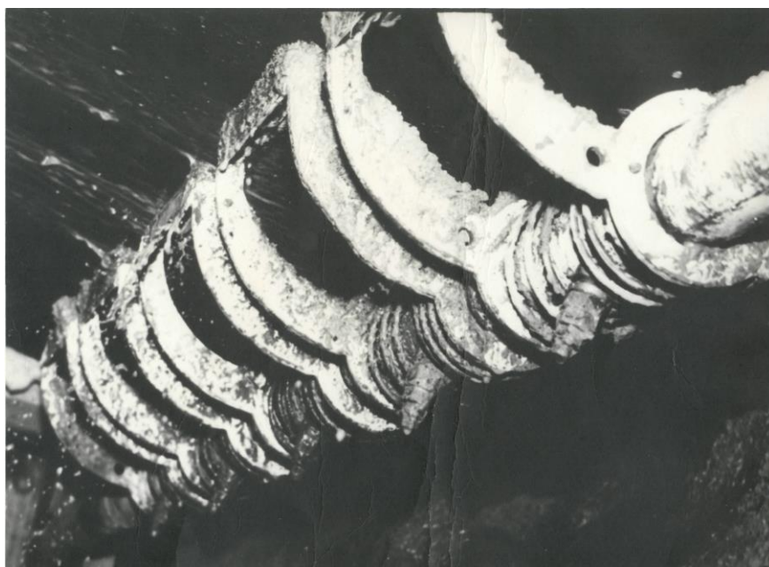
Рис. 11. Один ряд очистных элементов на производственных испытаниях устройства ОФ № 3 АК Алроса
