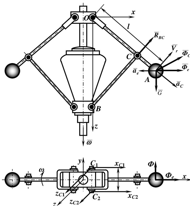
Рис. 4. Определение дополнительного давления, вызываемого ускорением Кориолиса
