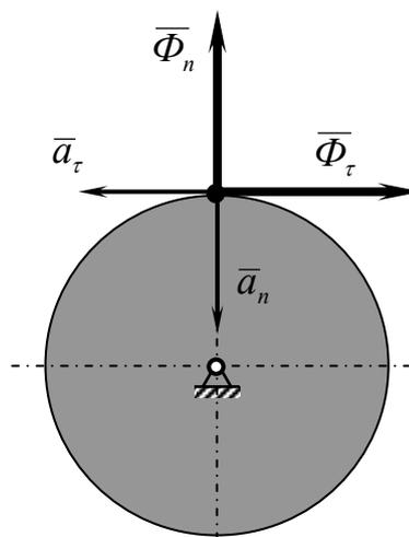
Рис. 2. Составляющие силы инерции и ускорения точки, принадлежащей вращающемуся телу
