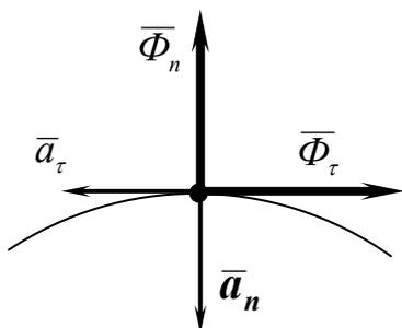
Рис. 1. Составляющие силы инерции и ускорения точки при ее движении по кривой
