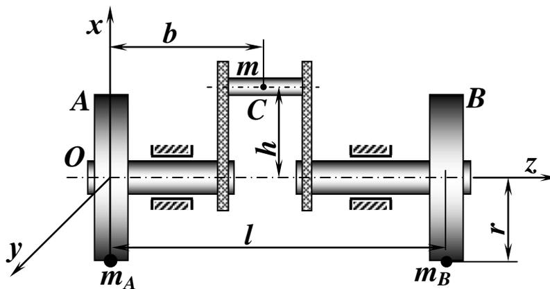
Рис. 5. Балансировка коленчатого вала одноцилиндрового двигателя
