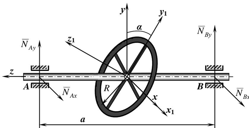
Рис. 3. Определение динамического давления на подшипники
