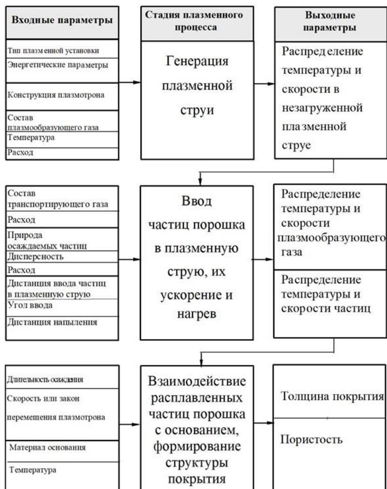
Рис. 2. Схема интегрированной математической модели процесса плазменного напыления покрытий из порошковых полимерных материалов
