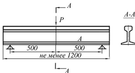
Рис. 2. Схема испытания на статический поперечный изгиб
