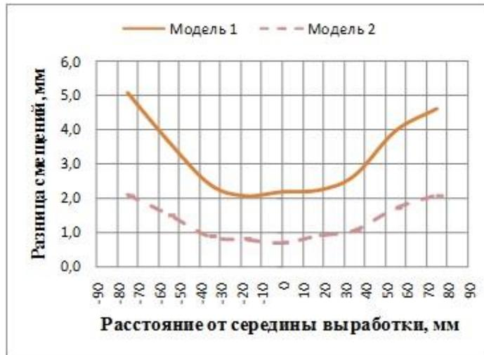
Рис. 7. Зависимости изменения смещений марок в ряду 4 почвы выработки:
