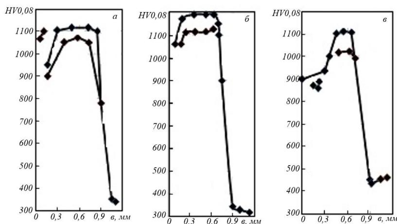
Рис. 2. Изменение микротвердости (HV 0,08) по глубине ( $z$ ) зоны плазменной закалки сталей
