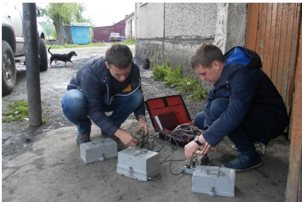
Рис 5. Установка датчиков СМ-ЗКВ в пос. Гавриловка студентами
