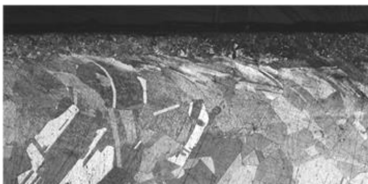
Рис. 1. Структура, \times 100 , поверхностного слоя меди после трибометаллургической обработки
