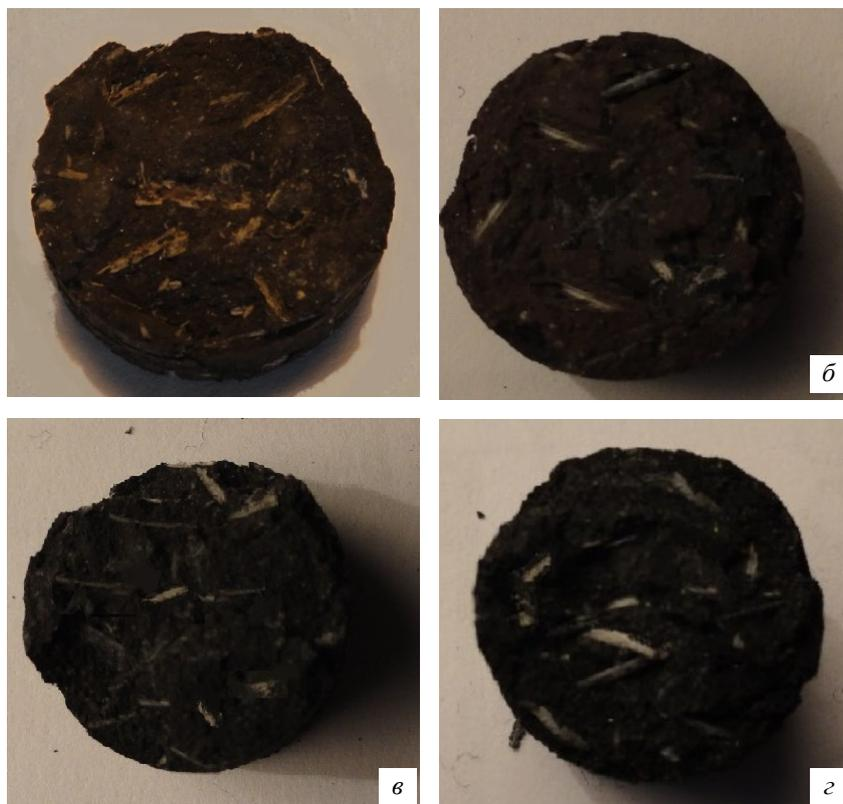
Рис. 7. Макроструктура излома брикетов после сушки при  $t_{об} = 100$  °C (а, в) и высокотемпературного обжига при  $t_{об} = 500$  °C (б, г) (количество ПД РП 2 %):
