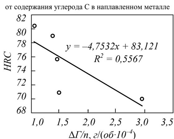
Рис. 3. Зависимость скорости истирания ( $\Delta Г/н$ ) от твердости образцов (HRC)
