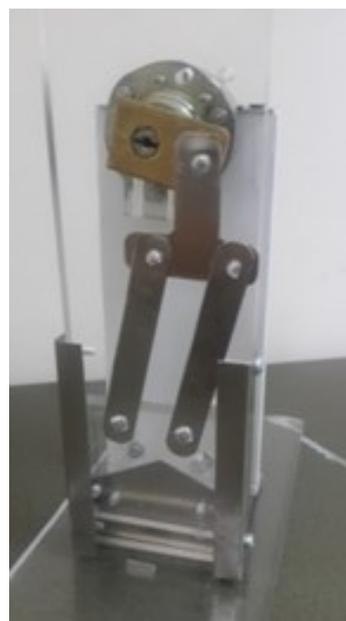
Рис. 3. Кинематическая схема (а) и прототип (б) ГРМ нового кривошипного пресса
