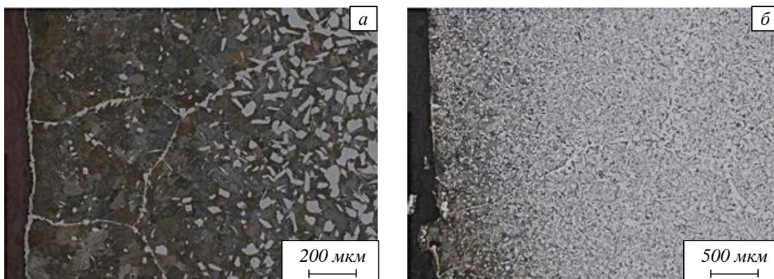
Рис. 3. Структура образцов боковой поверхности без модификатора (а) и с модификатором (б) после нормализации по режиму I
