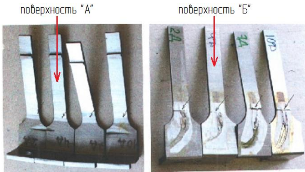
Рис. 12. Внешний вид и место разрушения образцов (указано стрелкой) с утолщенными границами зерен Fig. 12. Appearance and location of destruction of samples (indicated by arrow) with thickened grain boundaries
