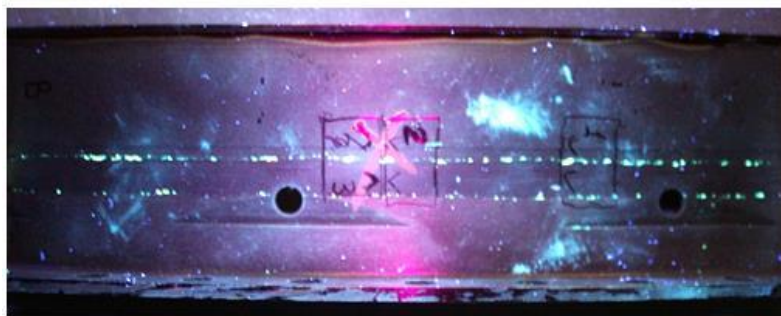
Рис. 2. Свечения в зоне сварного соединения Fig. 2. Glow in the weld zone
