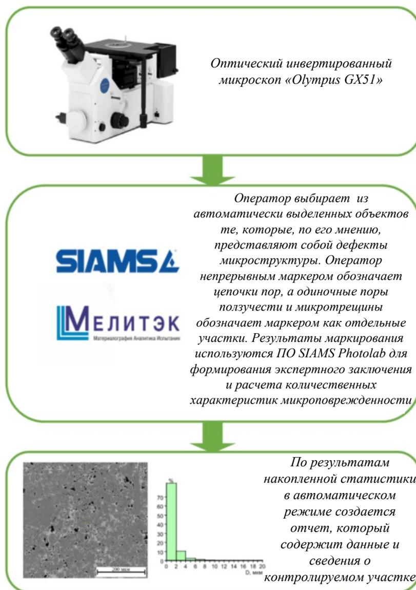
Рис. 2. Блок-схема методики исследования пористости сплавов
