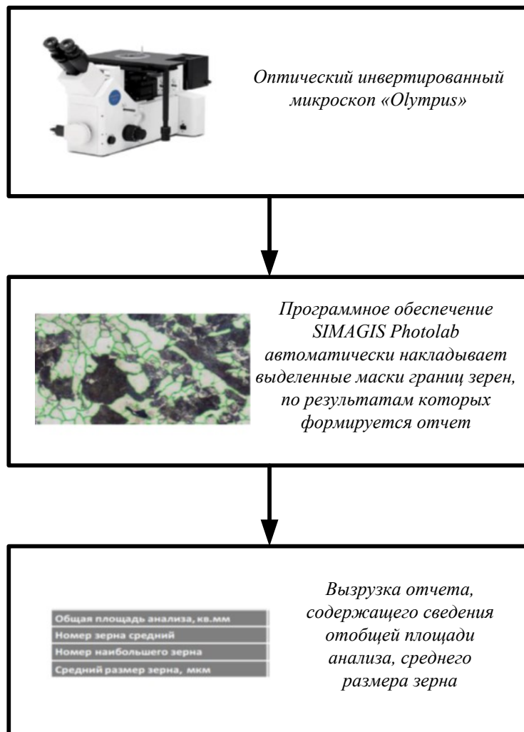
Рис. 2. Блок-схема методики исследования размера зерна Fig. 2. Block diagram of the grain size research methodology
